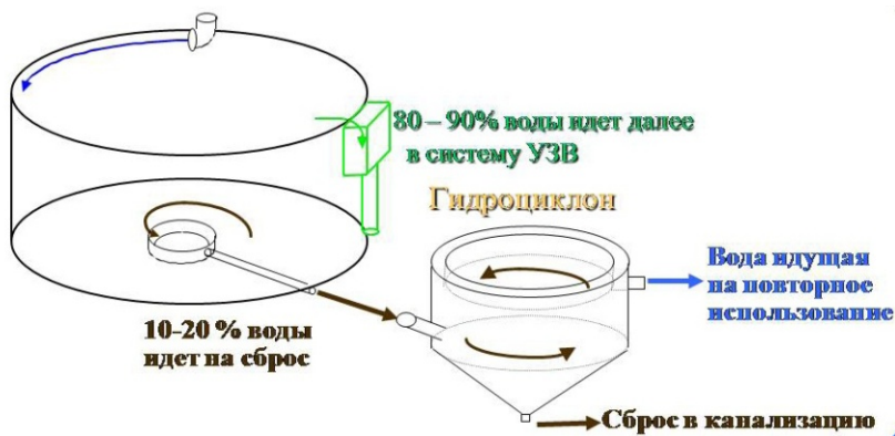
Рис. 3.5. Центральный слив в круглых бассейнах
